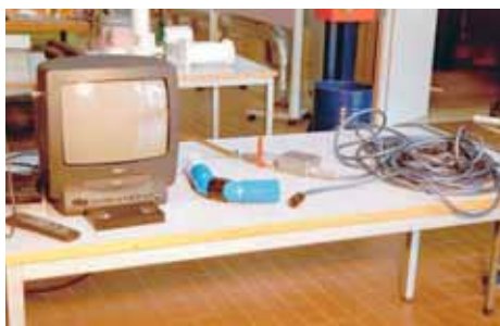
Abbildung 51: Inspektions- und Reinigungseinrichtung: IR-Kamera und Druckluft-Reinigungskopf an flexiblem Schlauch. Monitor für Online-Anzeige (SM Heag).
